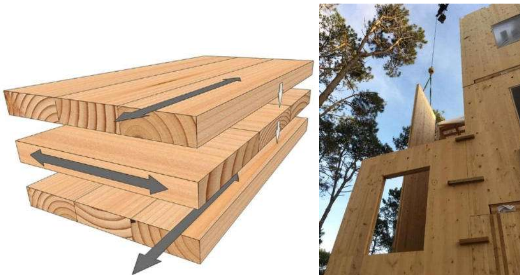
Imagen 6 - Esquema composición panel CLT.
